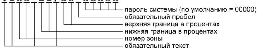
Границы задаются в процентах от максимального значения (равного напряжению на клеммах аккумулятора).
