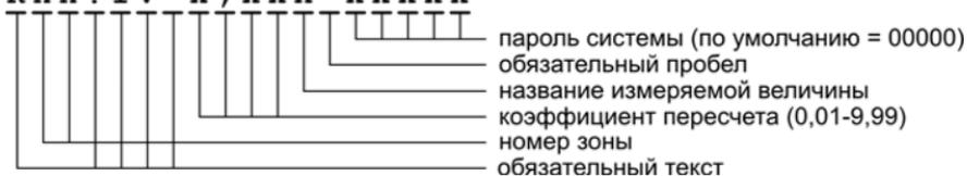
Например, если к 4-му входу подключен аналоговый манометр и 1 Вольт на входе соответствует давлению в 2,43 атм, то следующее SMS:
