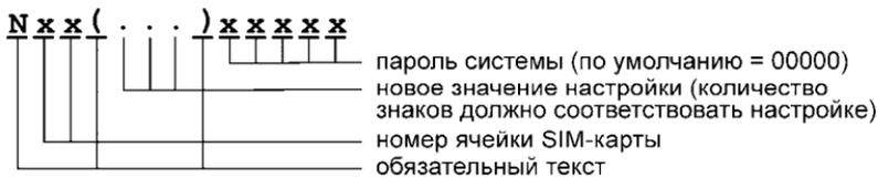
Т.к. для системы актуальны только настройки, записанные на основной SIM-карте, то после поступления SMS с командой изменения настроек система перезапустится на основной SIM-карте, изменит на ней нужную запись и переконфигурируется в соответствии с этой записью.
