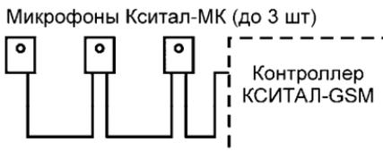
Для подключения микрофона "Кситал-МК" его выход просто соединяется с входом контроллера 10-метровым шнуром, входящим в комплект микрофона.
