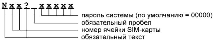
Если какая-либо запись, отвечающая за настройки системы, отсутствует в соответствующей ячейке телефонного справочника, то при включении контроллер создаст ее со значением по умолчанию.
