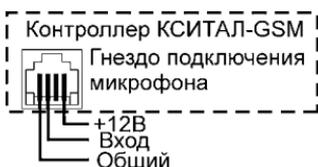
При необходимости к входу этого микрофона может быть подключен ещё микрофон "Кситал-МК". В такой цепочке допускается соединять до 3 шт. микрофонов "Кситал-МК", которые будут работать одновременно.
