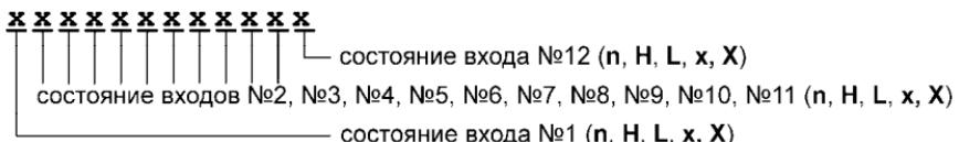
Состояние каждого входа отображается в виде символов:
